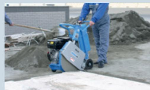
**Série SM** - Cortadores de pavimento; Três modelos, dos 70 aos 131 kg, com discos de 350 a 500mm de diâmetro
