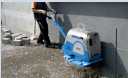
**Série CR** - Placas vibratórias reversíveis; Nove modelos, dos 103 aos 900 Kg, com bases de 40 a 95cm de largura
